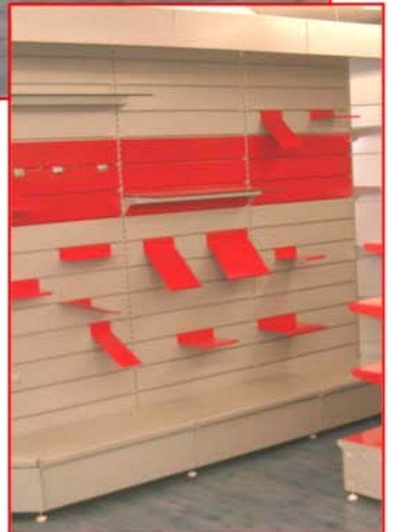
La serie Omega, fabricada en serie con chapa laminada en frío con espesores de 0,6 a 2,5 mm con calidad AP02. Una vez mecanizadas las diferentes piezas son sometidas a un proceso de protección consistente en limpieza-desengrase-fosfatado-aclarado-pasivado y secado a 140° C y pintado con polvo epoxi-poliéster y polimerizado a 190° C.
